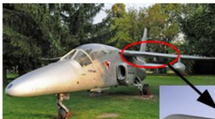
Umiejscowienie klapy Fowlera samolotu IRYDA I22 M-93.
