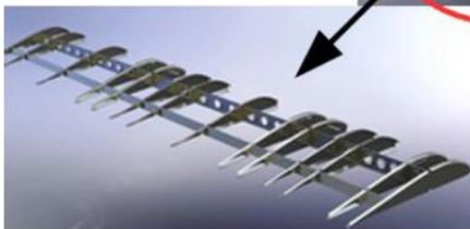
Struktura wewnętrzna klapy Fowlera samolotu IRYDA I22 M-93.
